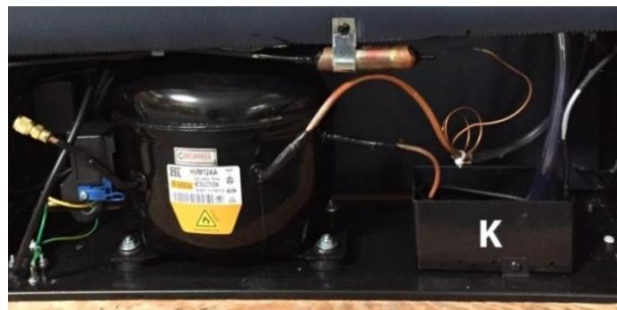
неисправности в работе прибора. При необходимости удалите конденсат из емкости для конденсата при помощи губки. Емкость для конденсата находится на задней части прибора справа внизу. Снимите металлическую крышку и снова прикрутите ее.
